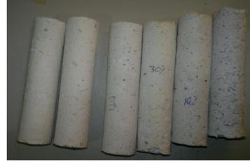
شكل (2): العينات الورقية المستخدمة في فحص معامل التوصيل الحراري.
