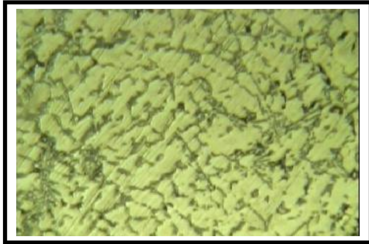
شكل (2) البنية المجهرية لسبيكة محرك وتحتوي على سليكون بحدود 12% وبدون عناصر سبك اخرى
