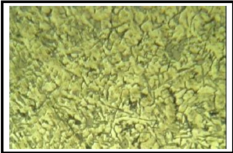
شكل (3) البنية المجهرية لسبيكة البستن وهي ذات محتوى سليكون بحدود 15%
