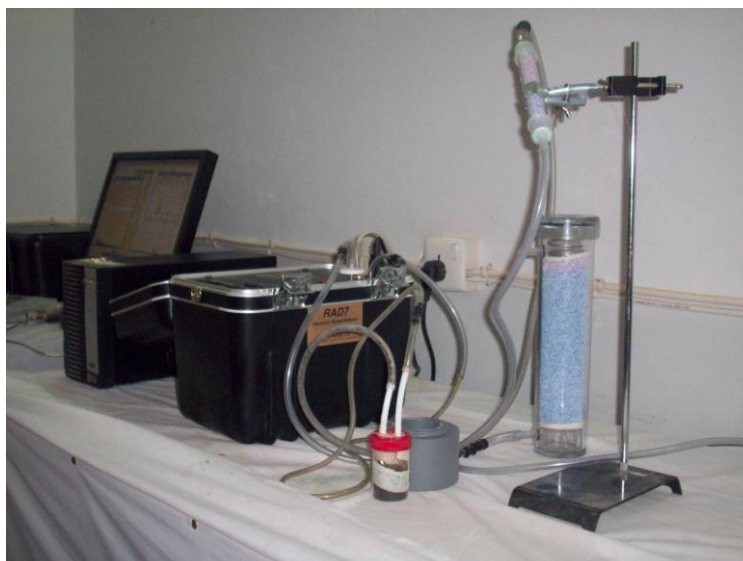
شكل (3) صورة لجهاز RAD7 المستخدم لقياس غاز الرادون ^{222}\text{Rn} في عينات الخبث (Sludge).
