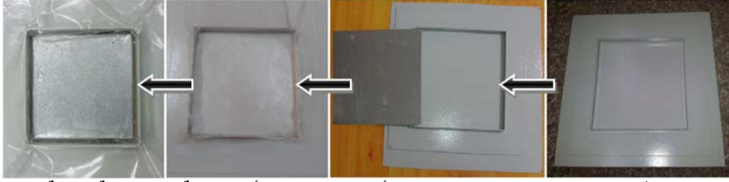
الشكل رقم (١) : يوضح القالب المستخدم وهو بأبعاد 20x20 cm لأجراء تقنية صب القوالب اليدوية .
