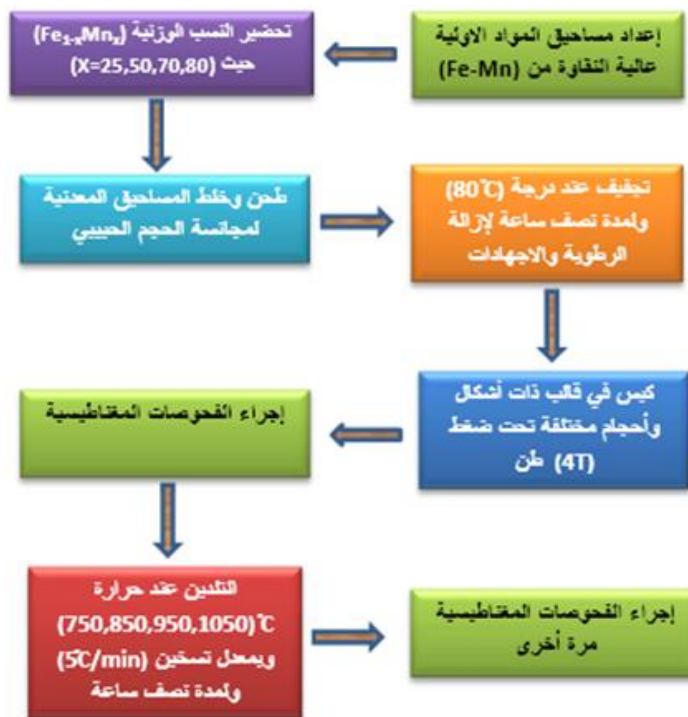
الشكل (2) : المسلك التكنولوجي التوضيحي لمرحلة تحضير النماذج المدروسة بطريقة ميتالورجيا المساحيق
