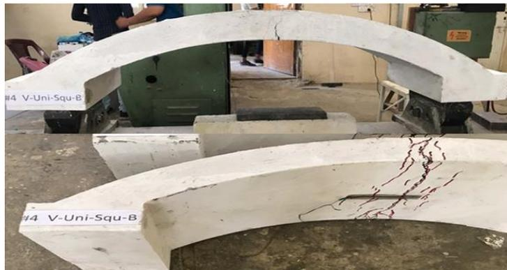
Figure 11. Crack Patterns of (V-Uni-Squ-B)
