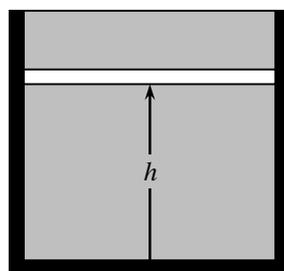
Fig.(4) One longitudinal rib parallel to the free edge
