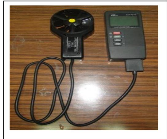
Fig. 9. Digital Anemometer.
