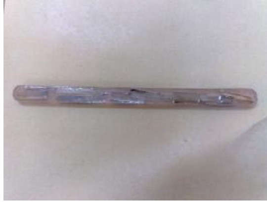
الشكل رقم (5) يوضح رسم تخطيطي لشكل العينة المستخدمة في اختبار الصدمة.
