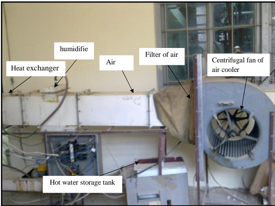
Fig. 5. The test rig.
