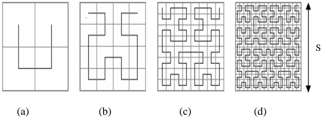
Figure. (1) Hilbert curve steps of growth: (a) 1<sup>st</sup> iteration (b) 2<sup>nd</sup> iteration (c) 3<sup>rd</sup> iteration, and (d) 4<sup>th</sup> iteration
