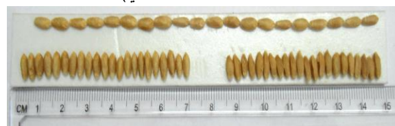
شكل 3. كيفية تثبيت حبوب الحنطة طوليا وجانبيا وعرضيا باستخدام شريط لاصق
