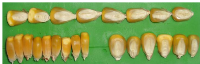
شكل 4. كيفية تثبيت حبوب الذرة الصفراء (كمنموذج آخر للحبوب) في مادة الطين الصناعي كمنموذج آخر من مواد التثبيت) لغرض قياس ابعاد الحبوب والذي يمكن استخدامه لجميع انواع الحبوب
