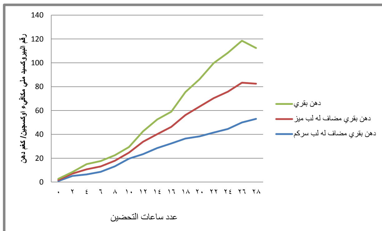
الشكل (1) تاثير مستخلصات لب الميز والسركم على الدهن البقري مع المقارنة بعينة السيطرة الى تطور رقم البيروكسيد
